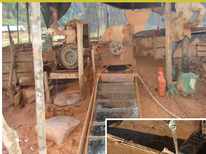
El uso de placas de cobre para la amalgamación de mineral en bruto en el Río Tapajós. Fotos: Proyecto Global de Mercurio
