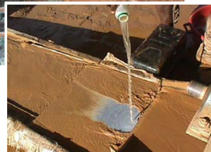
El uso de placas de cobre para la amalgamación de mineral en bruto en el Río Tapajós. Fotos: Proyecto Global de Mercurio
