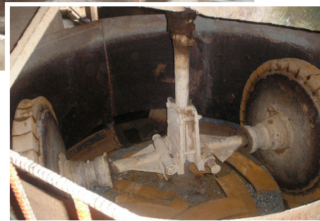
(Arriba) La planta de demostración en Portovelo, Ecuador para la capacitación de mineros artesanales. (Derecha) Un molino tipo trapiche común en Portovelo. Fotos: Marcelo Veiga
